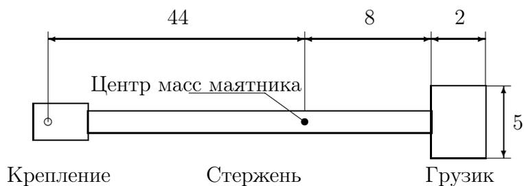
Рис. 2.4: Перевернутый маятник лабораторного стенда (все размеры указаны в сантиметрах)
